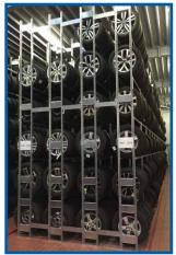
Bei der Vierfachbestückung der Reifenregale werden die Doppelregale paarweise hintereinander gestellt, ohne Zwischengang. Dadurch gehen mehr Reifenregale in den vorhandenen Lagerraum oder in die neu zu errichtende Reifenlagerhalle.
