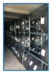
Bei der Doppelbestückung der Reifenregale werden die Reifen paarweise hintereinander gelagert, dadurch gehen mehr Reifenregale in den vorhandenen Lagerraum oder in die neu zu errichtende Reifenlagerhalle.
